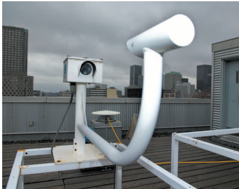
Oubliez les pluviomètres d'antan : le pluviomètre optique de la Station météorologique de l'UQAM utilise un faisceau laser transmis à un capteur. Photo : Nathalie St-Pierre
